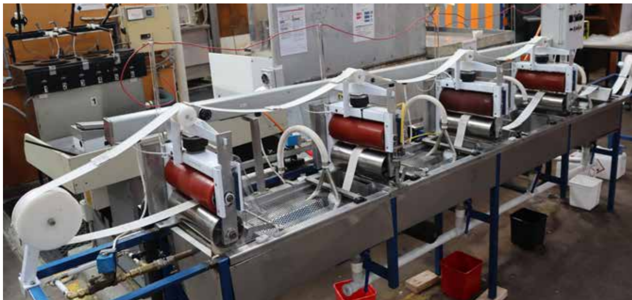
SGS专为检测羊毛在整个洗毛过程的表现而建造的迷你洗毛线
