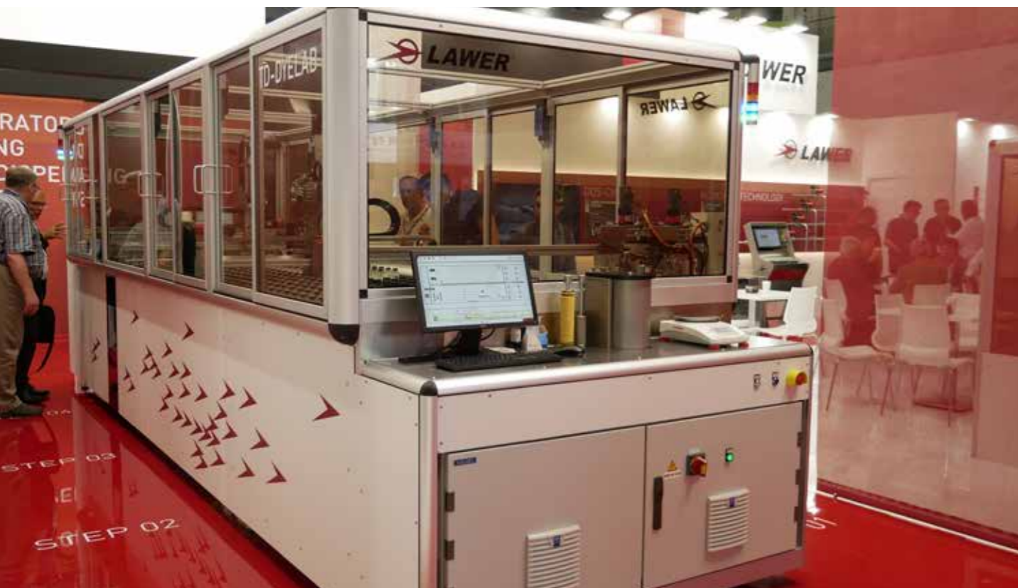
TD-MATIC自动粉末染料称重和溶化系统可以对少量粉末染料进行称重和溶化，制备液体溶剂，配送到实验室、取样机和生产染色机。
