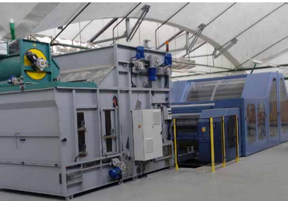
与Tecnomeccanica Biellese 公司共同研发的配有新容积式料斗的 Schlumberger精纺梳毛机
