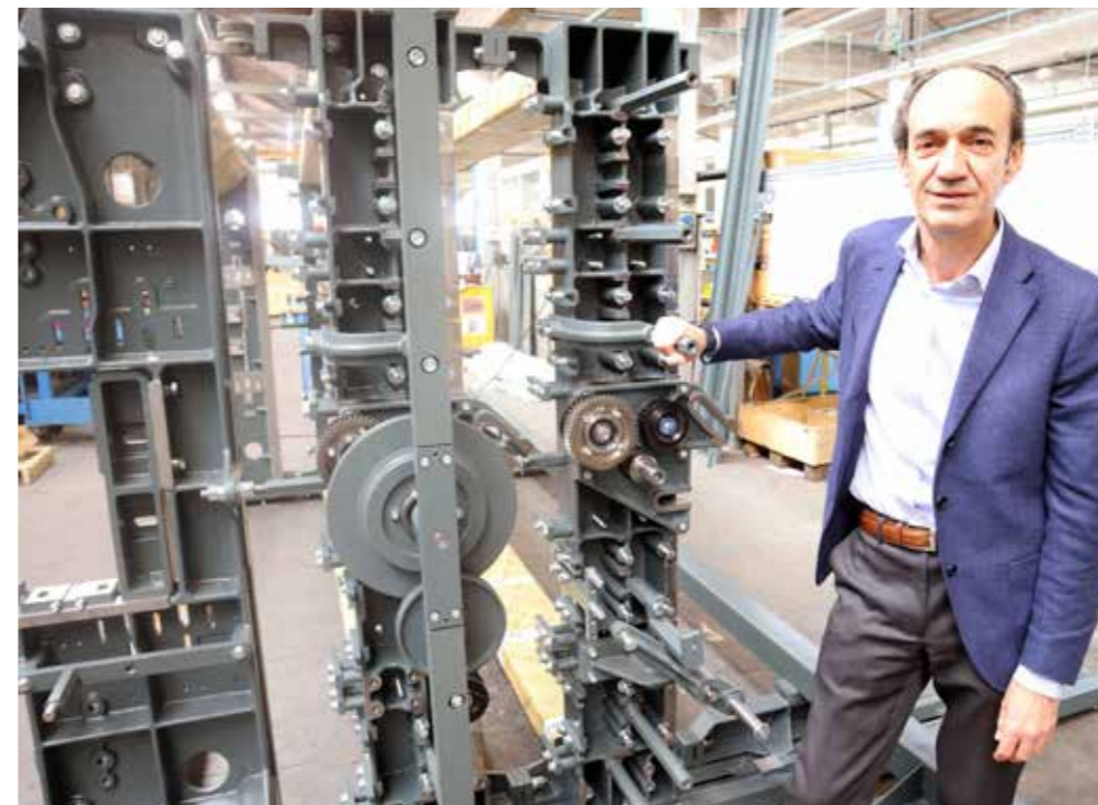
Giacomo Meucci与组装新梳毛机的新铸铁纱架 - 确保辊子和圆筒之间的设定保持稳定。
